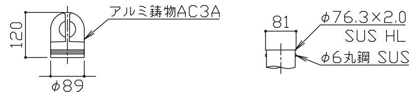
キャップ部/パイプ部詳細図 S = 1 / 10
